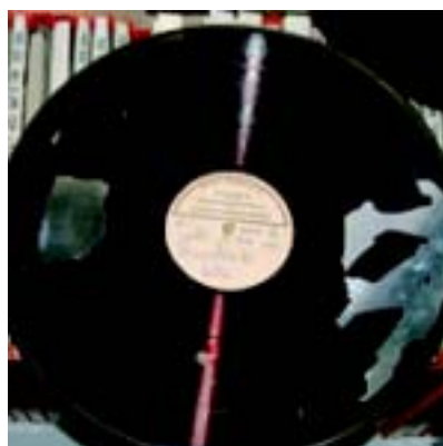
Disque à gravure directe détérioré
